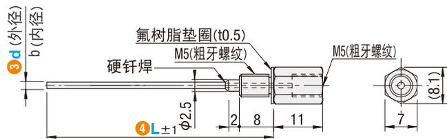
● 支柱固定安装型 **FFNZS** (L尺寸固定型) **FFNZSL** (L尺寸指定型)
