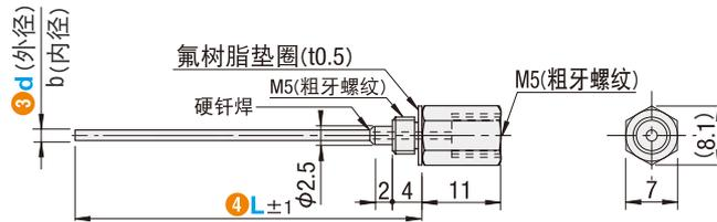
● 高度调整用外螺纹·内螺纹型 **FFNML** (L尺寸固定型) **FFNMLL** (L尺寸指定型)
