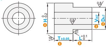
①当L长度过长时, 孔中间可能带有退刀槽。
