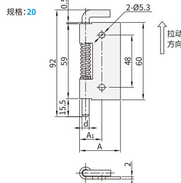
①结构说明:拉动销子脱离门框实现拆卸。
